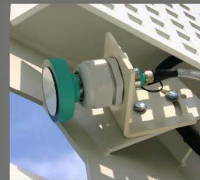
Die Anlage ist mit einem Ultraschall-Näherungssensor ausgestattet, welcher je nach Beladungsart vorn oder hinten angebracht ist und der bei Annäherung des Beladegerätes das Siebdeck aktiviert und nach einer voreingestellten Zeit wieder abschaltet. Optional besteht die Möglichkeit, die Siebanlage mit 2 Stück Näherungssensoren auszustatten, um eine beidseitige Beschickung des Siebes zu ermöglichen.
