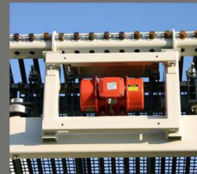
Der Antrieb der Siebdecks erfolgt mit 2 Stück Erregermotoren. Die Leistung der Motoren beträgt jeweils 1,1 kW Die Stromaufnahme ca. 2A Betrieb mit Stromaggregat 5 kW möglich. Die Drehrichtung der Erregermotoren kann durch einen Polwendestecker geändert werden und ist bei schwer zu siebendem Material entgegen der Förderrichtung.
