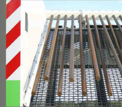
Der Stangensizer ist neigungsverstellbar und kann im gespreizten Verlauf oder in Parallelanordnung, je nach Einsatzbedarf, montiert werden. Das komplette Siebdeck hat eine Neigungsverstellung durch vierfach verstellbare Standfüße.
